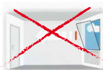
Die Kippstellung ist wirkungslos und verschwendet Heizenergie.
